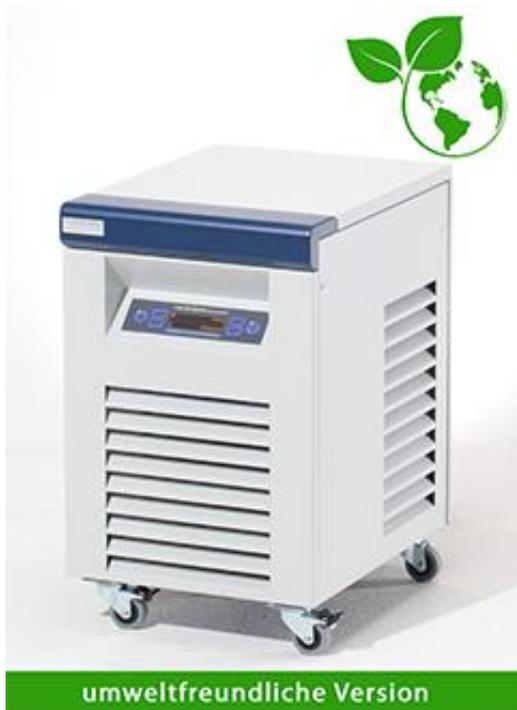
Der MINORE® ist ein kleiner Umlaufkühler, der als 300 Watt, 350 Watt und 500 Watt Version erhältlich ist. Ein Kälteaggregat kühlt das umlaufende Wasser, bzw. Frostschutzgemisch, in einem kleinen Behälter ab, aus dem es mittels Umwälzpumpe abgesaugt und zur zu kühlenden Einheit befördert wird.
